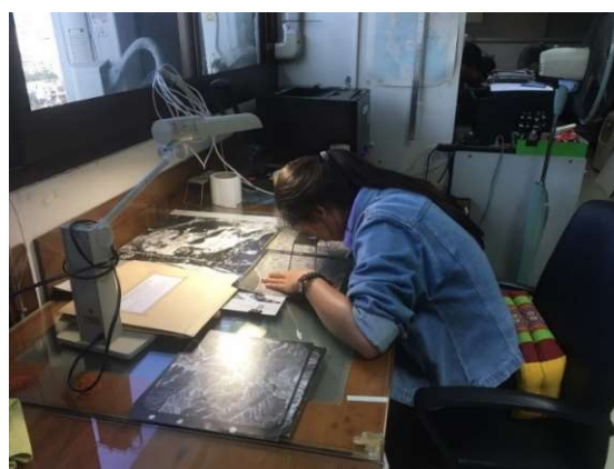
ภาพที่ 42 อ่าน แพล ตีความภาพถ่ายทางอากาศในสำนักงาน โดยใช้ กล้องมองภาพสามมิติ ชนิดกระจกเงา (Mirror Stereoscope)
